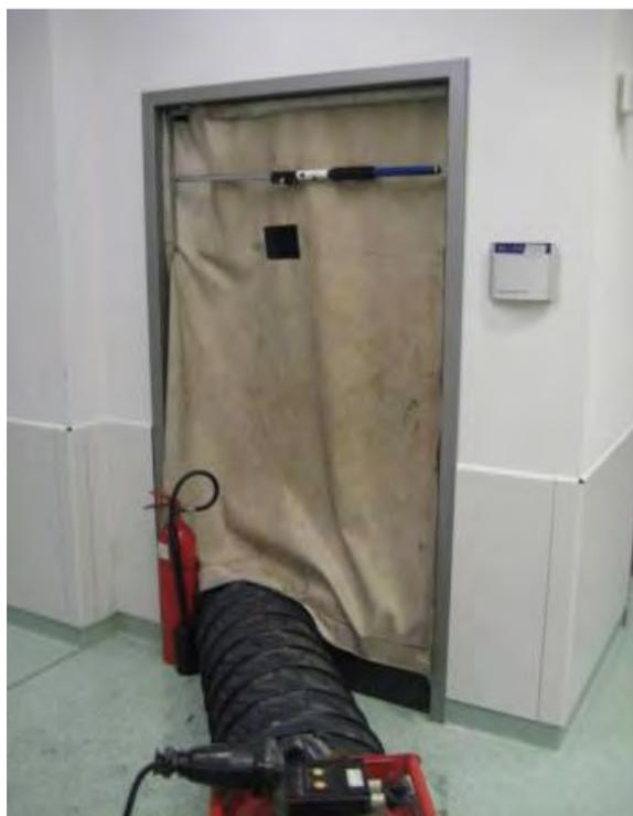
Brand in Uniklinik: Effektive und saubere Rauchableitung aus einem fensterlosen Raum mit Hilfe eines Be- und Entlüftungsgerätes in Kombination mit dem mobilen Rauchverschluss.
